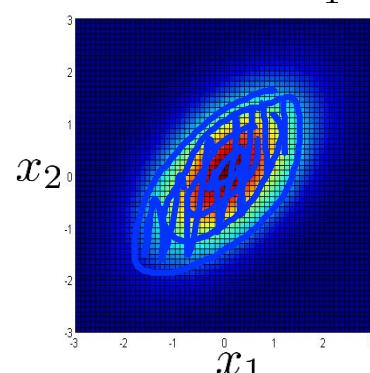
$$\mu = \begin{bmatrix} 0 \\ 0 \end{bmatrix} \Sigma = \begin{bmatrix} 1 & 0.8 \\ 0.8 & 1 \end{bmatrix}$$
