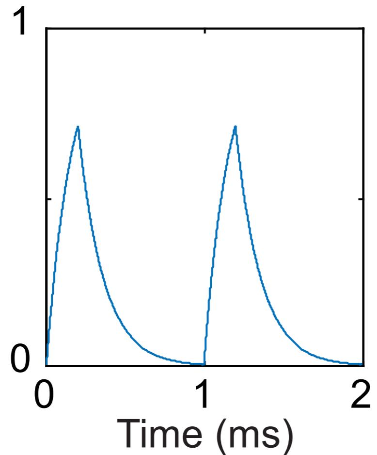
$$\left(1 - e^{-t/RC}\right) u(t) - \left(1 - e^{-(t-\Delta)/RC}\right) u(t - \Delta)$$
