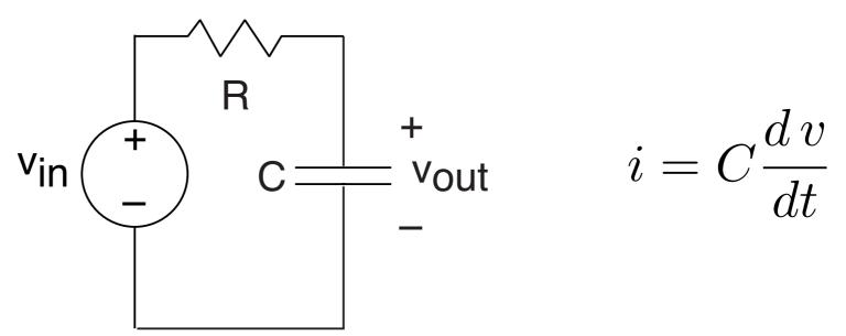
$$RC\frac{d\,v_{\rm out}}{dt} + v_{\rm out} = v_{\rm in}$$
