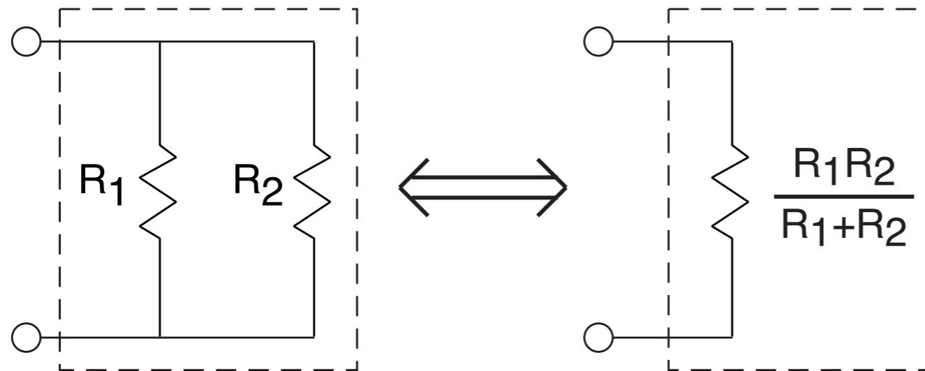
$$R_1 \parallel R_2 \equiv \frac{R_1 R_2}{R_1 + R_2}$$
