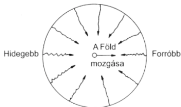
1.7. ábra: Az ősrobbanás maradványaként jelen lévő mikrohullámok izotróp tengerében végzett mozgásunk. A sugárzás abból az irányból a legerősebb, amerre mozgunk, míg az ezzel ellentétes irányból a leggyengébb. A két irány közt az intenzitás jellegzetes koszinuszos változása figyelhető meg.
