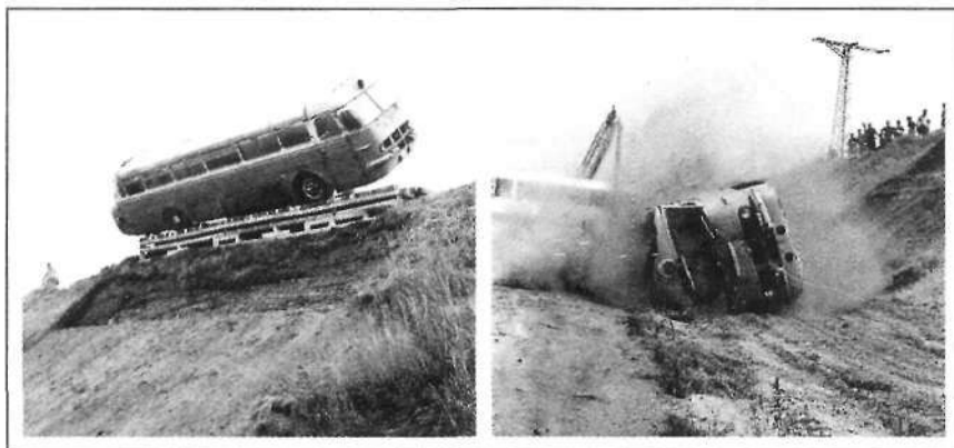
2. ábra. Az első magyar lejtős borítóvizsgálatok egyike ■ a legendás IK-55 típusú autóbusz 1972-es felépítményvizsgálata
