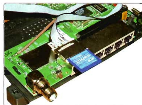
A DD-WRT segítségével a házilag beépített SD kártyaolvasó is használható
