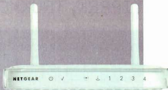
Netgear KWGR614 WLAN router: nem csak MIMO-s, de a divatnak megfelelően nyílt forráskódú
